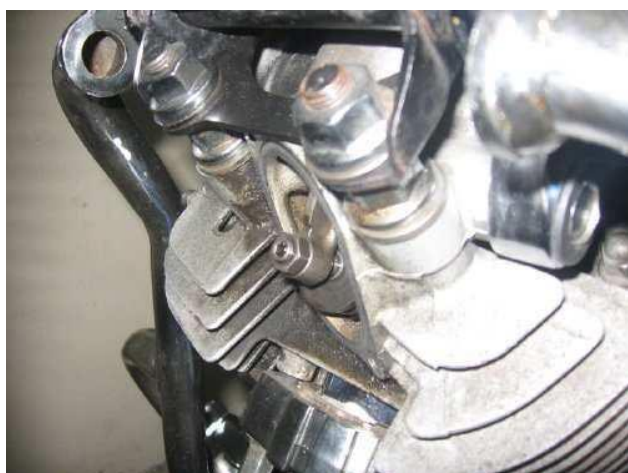
a tutaj jest widoczna dźwigienka zaworowa zaworu wydechowego przedniego cylindra.
